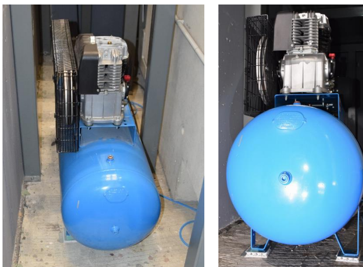
Rys. 6. Sprężarka z zastosowanym przykładowym ustrojem antywibracyjnym 3D podczas badań weryfikacyjnych w warunkach rzeczywistych
